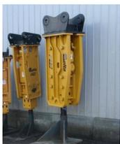
Гидравлические молоты в зависимости от типа привода ударной части разделяются на три группы: собственно гидравлические, гидропневматические, гидромеханические.
