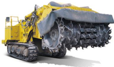
Землеройно-фрезерные машины применяются для массовых земляных работ на переувлажненных грунтах. Они разрабатывают с одного прохода забой с поперечным сечением 3-6 кв. метров, с последующим продвижением в забое. Землеройно-фрезерные машины относятся к типу машин непрерывного действия.
