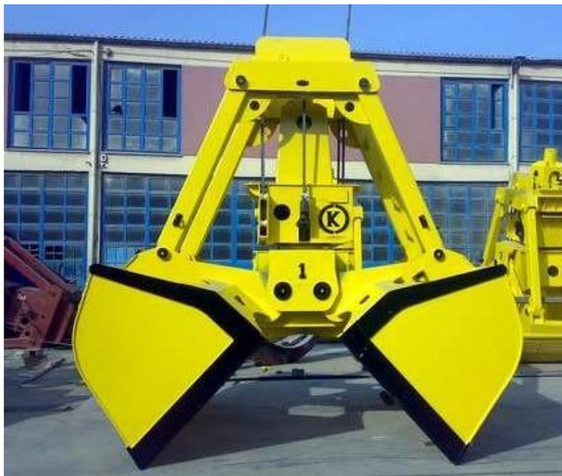
Для кранов, выполняющих операции с грейфером, используют грейфер двухканатный и грейфер четырехканатный. В этом случае кран оснащают двумя механизмами для подъемного и замыкающего канатов. Двухканатный и четырехканатный грейферы идентичны в кинематическом отношении, но в двухканатных грейферах канат создает простой полиспаст, а в четырехканатных – сдвоенный полиспаст.
