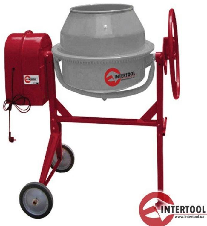
В линейке бетоносмесителей INTERTOOL бетоносмеситель INTERTOOL DT-9180 представляет собой самую большую модель по объему бака, который составляет 180 л. Данную модель можно использовать для строительства домов, заливки фундамента под различные строения, хозяйственных построек, стяжки полов. Бак в DT-9180 вращается с частотой 30 об/мин, и электродвигатель потребляет 550 Вт электроэнергии.
