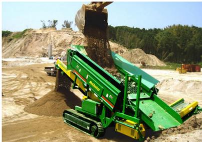
Сортировочные машины или грохоты применяются для строительных работ, связанных с процессом разделения и сортировки по классам таких сыпучих материалов, как песок, щебень и гравий. Основным элементом такой машины является просеивающая поверхность, в зависимости от вида которой грохоты подразделяются на следующие виды:
