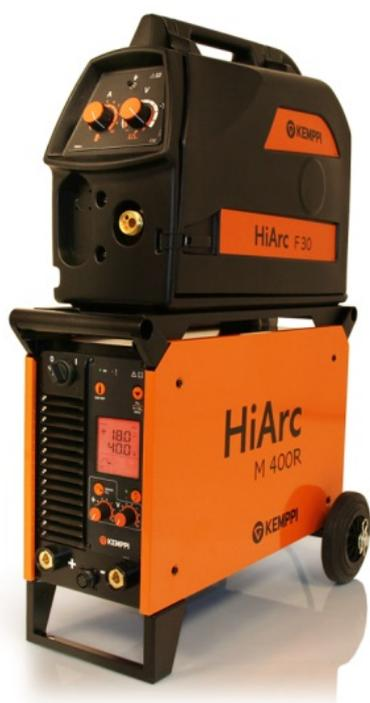
Сварочный аппарат HiArc M400R применяется для полуавтоматической сварки в среде защитных газов (Ar/CO<sub>2</sub>), используя сварочную проволоку Ø 0,8-1,6 мм. Этот полуавтомат может эксплуатироваться в опасных условиях, на открытых и закрытых площадках при температуре окружающей среды от минус 20°C и до плюс 40°C, повышенной влажности. Полуавтомат способен длительное время работать на максимальном токе 400А при температуре плюс 40 °С.
